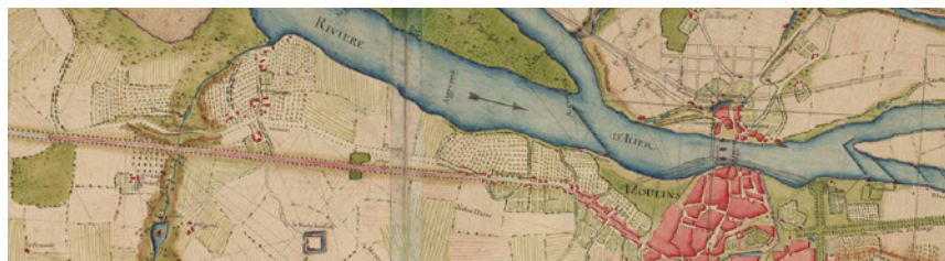
Atlas Trudaine, généralité de Moulins, détails du plan d'urbanisme envisagé par Louis de Régemortes à Moulins, 1755. Sur le plan figurent le tracé du nouveau pont, des digues, du nouvel aménagement urbain envisagé pour le faubourg de la Madeleine. Dans le lit de l'Allier figurent, en rouge, les anciennes piles du pont Ginguet et du pont Mansart.
