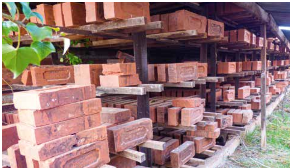
13. Le tunnel de séchage des briques de la tuilerie de Bomplein à Couzon
